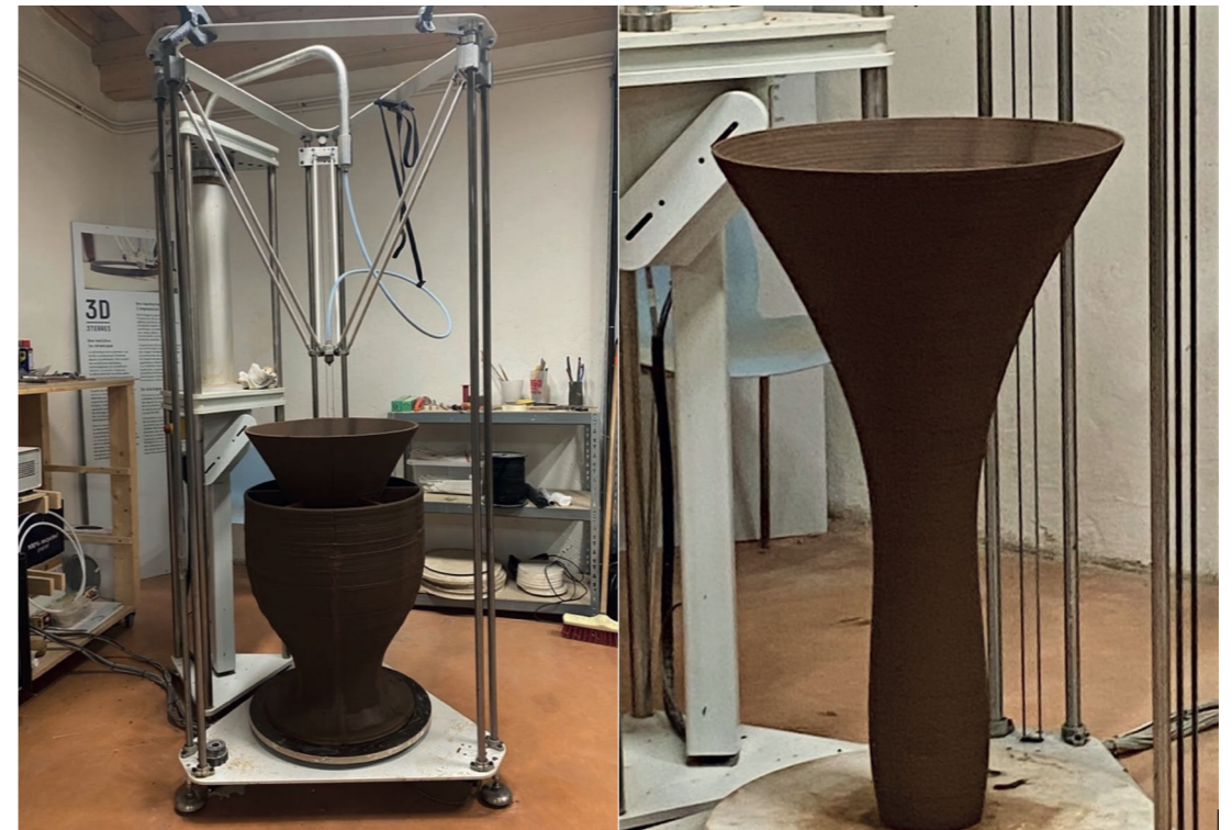
Fig.7 ZEITGEIST#3. Impression 3D céramique d'un double pavillon au 8fablab de Crest, à partir d'un modèle d'optimisation acoustique des tempéraments harmoniques relevés d'une Long-string de 30 mètres, en partenariat avec la Maison de la Tour à Valaurie et la plateforme MAS du LMA-CNRS, 2022.
