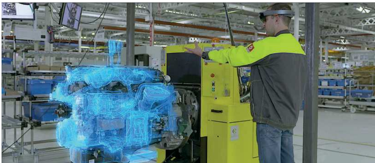
Contrôle qualité moteur dans l'usine de Renault Trucks à Vénissieux (près de Lyon) en Réalité Mixte grâce à l'HoloLens. Projet développé par Immersion pour Renault Trucks.
